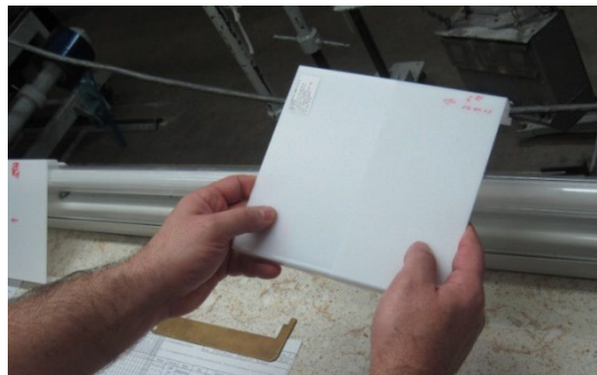
Abbildung 7: Draufsichtprüfung im Auflicht; Arbeitsplatzleuchte (Durchleuchtung) ist ausgeschaltet
