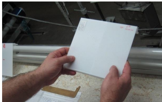
Abbildung 7: Draufsichtprüfung im Auflicht; Arbeitsplatzleuchte (Durchleuchtung) ist ausgeschaltet
