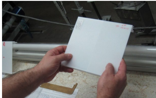
Abbildung 8: Draufsichtprüfung im Auflicht; Arbeitsplatzleuchte (Durchleuchtung) ist ausgeschaltet
