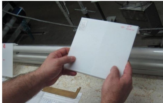
Abbildung 8: Draufsichtprüfung im Auflicht; Arbeitsplatzleuchte (Durchleuchtung) ist ausgeschaltet
